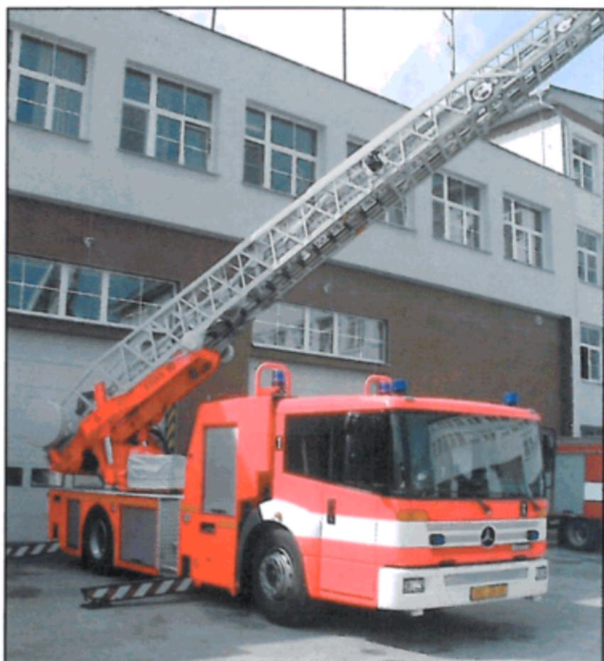
K záchraně osob z výškových budov a k hašení požárů nebo jiným technickým zásahům ve výškách se využívá výšková technika (na obrázku AŽ 30 EPAS CAMIVA MERCEDES ECONOMIC). Pro bezpečné použití výškové techniky je důležité její správné ustavení a vyložení stabilizačních podpěr na zpevněné ploše.
